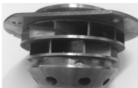
(b) 三级旋流器实物照片
